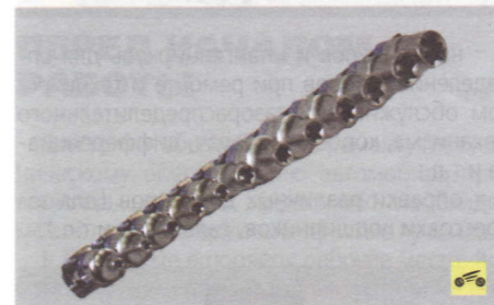
...и E. На автомобиле Ford Focus II большинство крепежных деталей выполнено под инструмент TORX;
