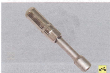
— свечные ключи «на 16» или «на 21» (в зависимости от типоразмера применяемых на вашем автомобиле свечей зажигания);
