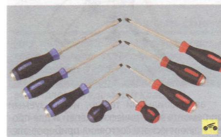
— набор отверток с плоским и крестообразным лезвиями разных размеров, с удобными ручками. При выборе отверток (особенно с крестообразным лезвием) будьте аккуратны, так как лезвие неподходящего размера может сорвать шлицы в головке винта;
